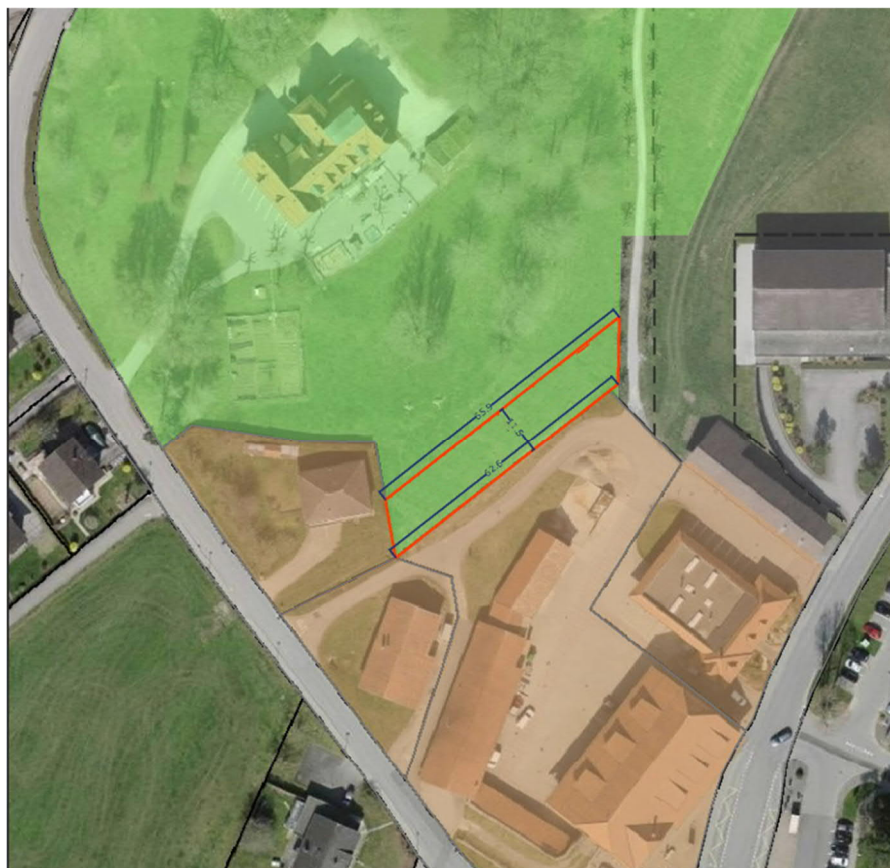
Figure 2: Périmètre constructible (en rouge) proposé à l'intérieur de la zone libre du parc d'Humilimont. Dimensions approx. 11.5m de largeur et 62-65 m de longueur.
